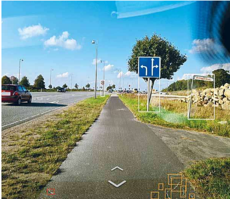
I billedet vises et eksempel, hvor de mindre revner i bunden af højre hjørne er registreret som fejl, da VD's måleteknikere klassificerede skaderne som en samlet krakelering.
