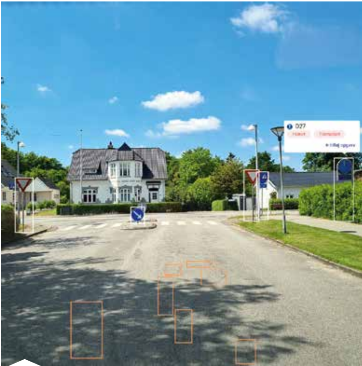
På billedet ses både registreringer af skilte, men også mindre revner, som systemet har identificeret.
